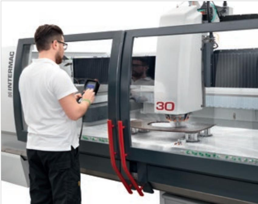
Commodité maximum des opérations grâce à la présence d'un clavier portatif pour permettre:
